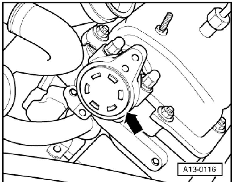
Mettre en place les arrêteurs d'arbres à cames -3458- sur les deux culasses et les fixer avec la chaîne pour qu'ils ne tombent pas.
