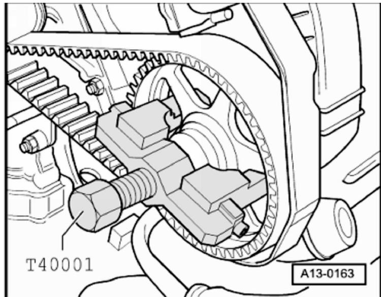
Commencer par placer la courroie crantée sur les pignons de courroie – crantée du vilebrequin et de l'arbre à cames droit, puis sur le galet-tendeur et le galet-inverseur ainsi que sur la pompe de liquide de refroidissement.
