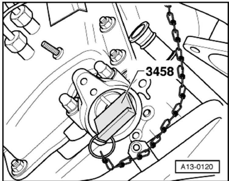
Déposer l'amortisseur de vibrations du pignon de pompe d'injection ; pour ce faire, déposer les vis -1-.
