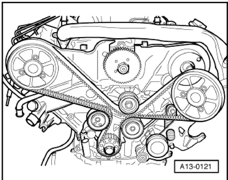
A l'aide d'une clé mâle pour vis six pans creux de 8 mm, délester le tendeur -flèche- et retirer le goujon calibré - T40011- du tendeur hydraulique.
